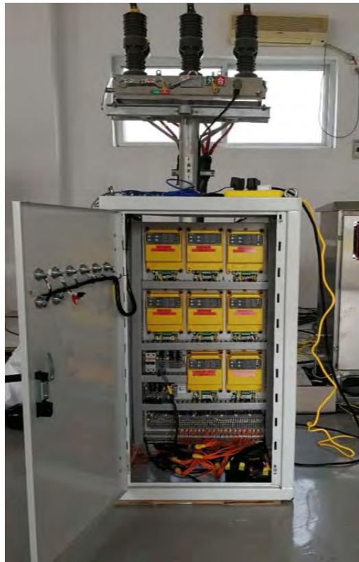
IPS2装置在真型试验中电气接线
