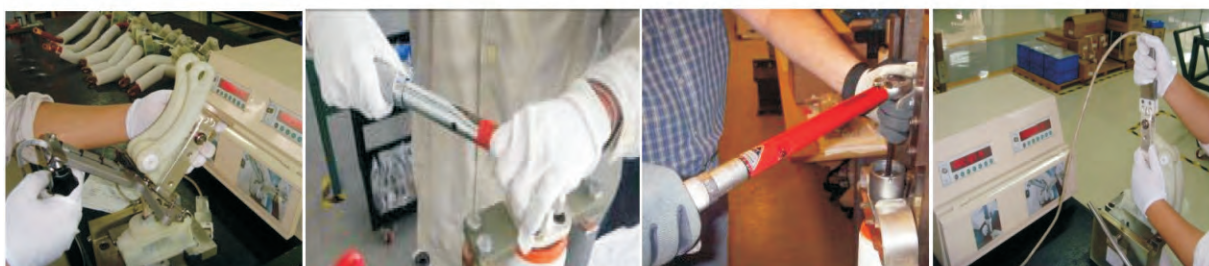
开关刀闸接触压力检测(1) 组件螺栓紧固扭矩控制(1) 组件螺栓紧固扭矩控制(2) 开关刀闸接触压力检测(2)
