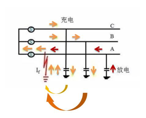
★ 发生接地故障瞬间,线路所有的电容电流都经接地点流向故障线路;
