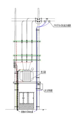
★ 变压器低压侧取电
